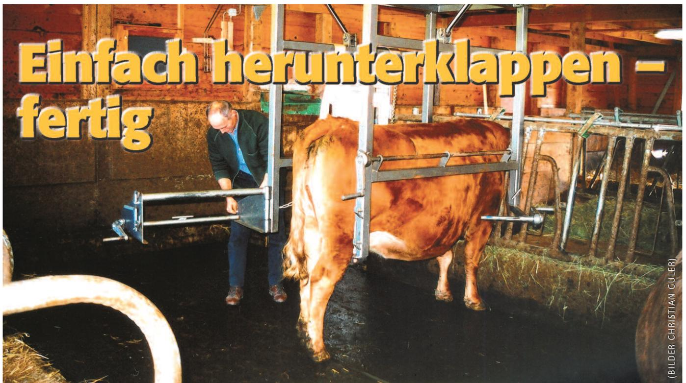
Das Rind nicht mehr aus dem Stall führen müssen und den Klauenstand permanent mitten im Laufstall in Bereitschaft haben? «Nichts ist einfacher als das», dachte sich Peter Studer und entwarf einen von der Decke herunterklappbaren Prototypen. Der mit dem Suisse Tier Anerkennungspreis ausgezeichnete Klauenstand stösst auf grosses Echo.
