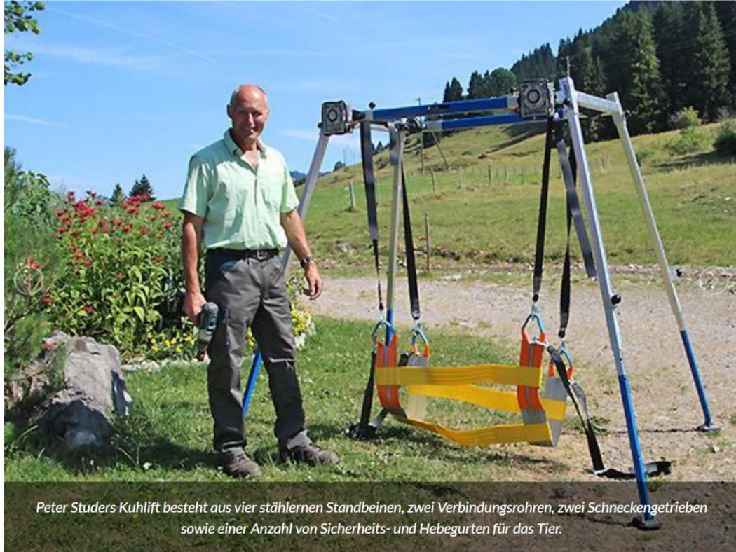
Peter Studers Kuhlift besteht aus vier stählernen Standbeinen, zwei Verbindungsrohren, zwei Schneckengetrieben sowie einer Anzahl von Sicherheits- und Hebegurten für das Tier.
